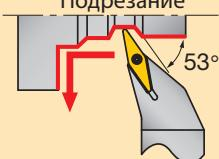
Исполнение режущей кромки H
