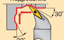
Исполнение режущей кромки Q
